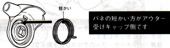
6. バネの長い方をレバー体の穴に入れて、アウター受けキャップを回しながら取り付けます。
