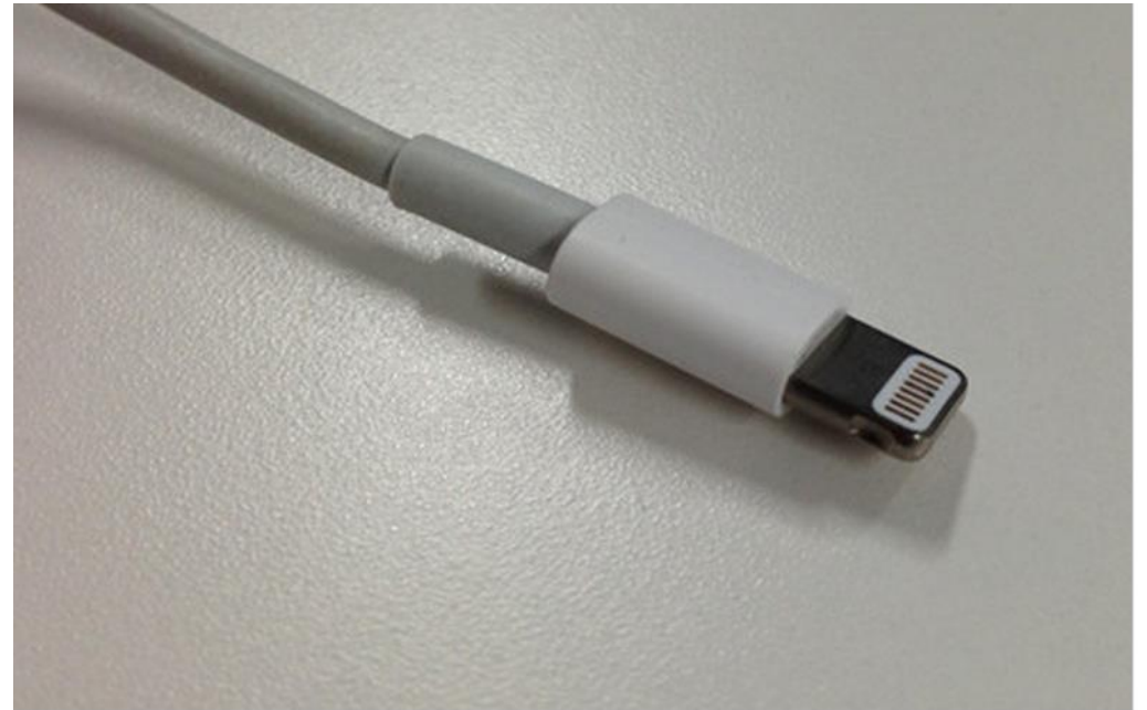
iPhone 5から採用された新型コネクタ「Lightning」。リバーシブル構造のため表裏を気にせず挿し込めるうえ、横幅約6.5mmとかなりスリムになりました
