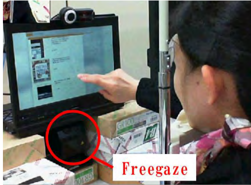
Fig. 2 操作滞留時検出実験の様子
